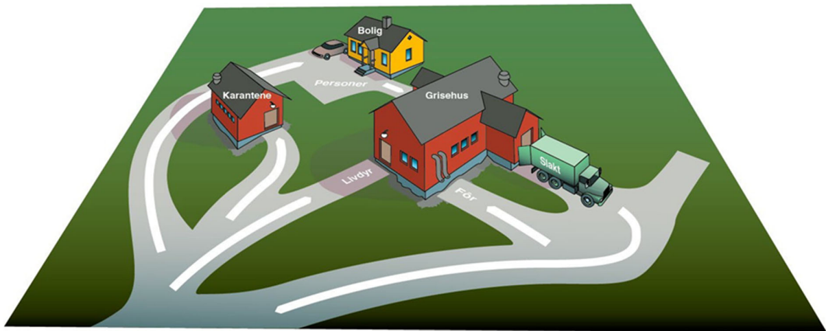
Figur 2.2. Utforming av et typisk norsk gårdstun. Fjøset er plassert med tanke på best og sikrest mulig trafikk og inn- og utslusing av livdyr, dyr til slakt; fôrleveranser og persontrafikk. Dette gir god smittebeskyttelse, men kan vanskeliggjøre utegang umiddelbart rundt fjøset. (Figur: Animalia).
