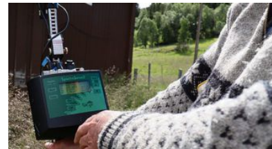
Jon Gudmundsson bruker dette instrumentet for å måle og samle inn data på hvor store mengder klorofyll som finnes per kvadratmeter. De sjekker både på innsiden og utsiden av gjerdet. Foto: Eline Håker
