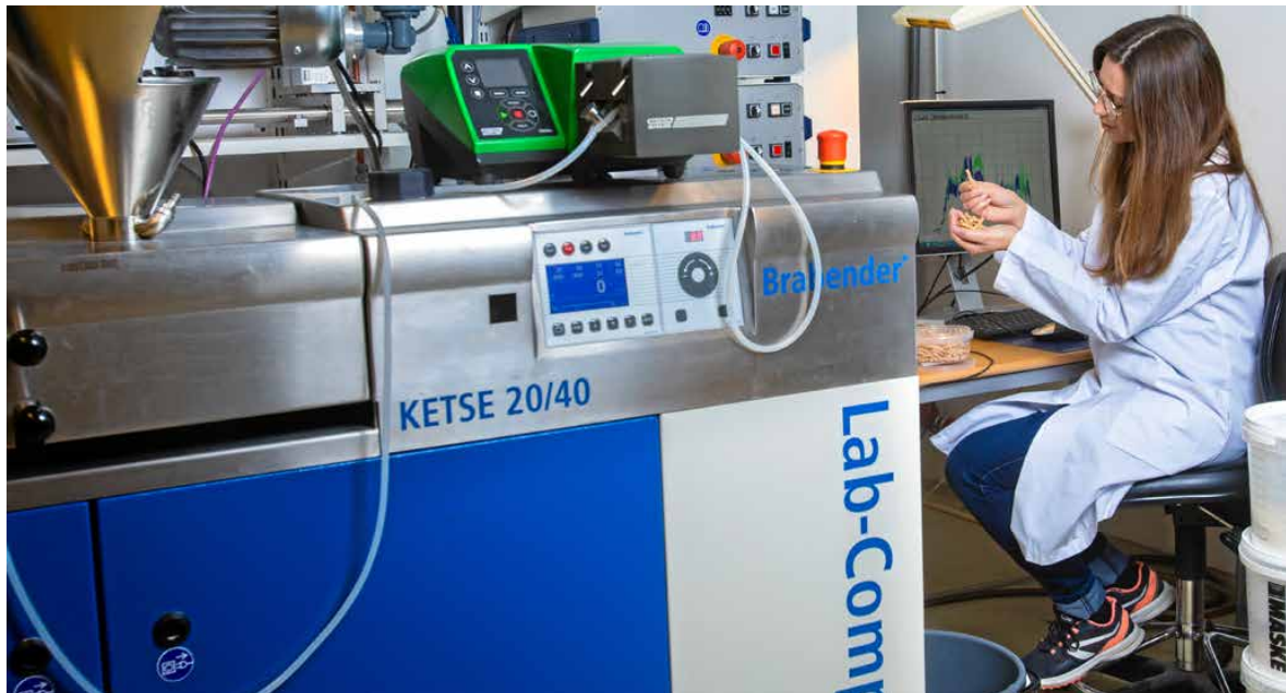
Ny teknologi: Ekstruderen er en maskin som bearbejder planeråstøff slik at det får ønsket form og egenskaper, som for eksempel tilnærmet kjøttstruktur. Forsker Catia Saldanha struderen.
